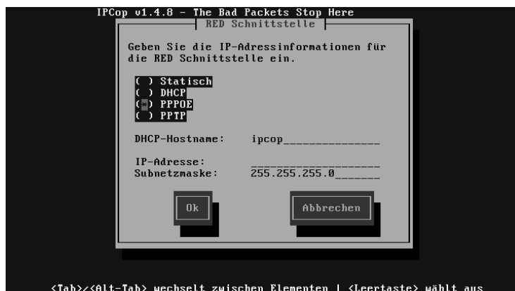
Abbildung 14.4: IPCop unterstützt die Internetanbindung mit PPTP, PPPoE, DHCP und statischer IP-Adresse.
