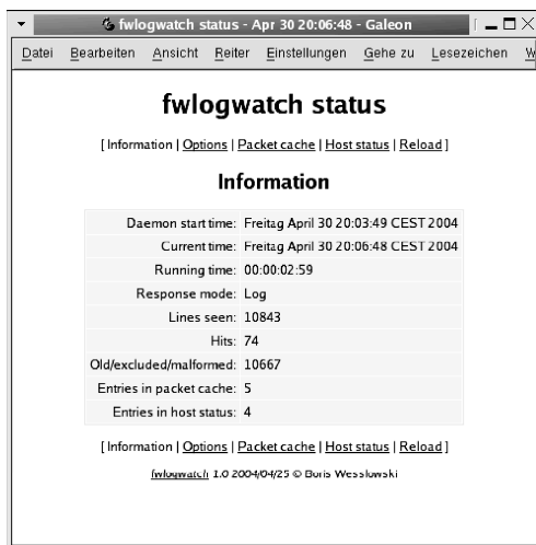
Abbildung 11.2: Im Echtzeitmodus kann Fwlogwatch seinen Status über ein Web-Interface anzeigen.
