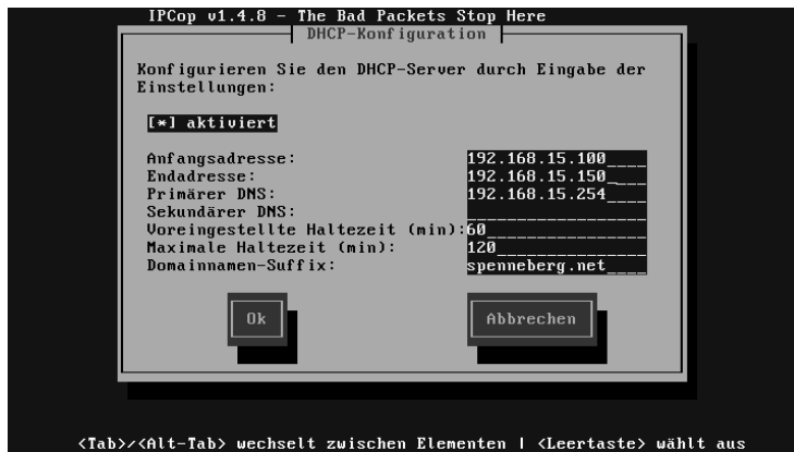
Abbildung 14.5: IPCop kann selbst als DHCP-Server für das grüne Netz arbeiten.
