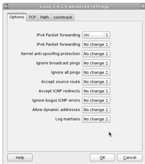
Abbildung 12.7: Firewall Builder bietet Ihnen auch die Konfiguration der Einstellungen im /proc -Verzeichnis.
