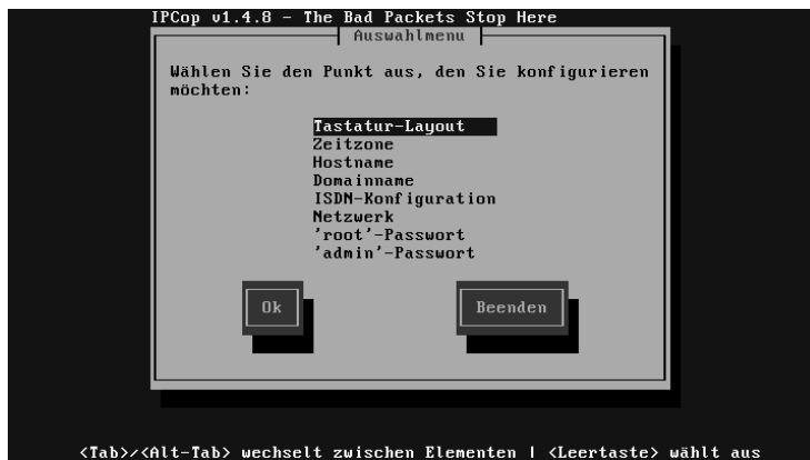
Abbildung 14.6: Ein Aufruf der Konfigurationswerkzeuge ist auf der Konsole mit dem Befehl setup möglich.
