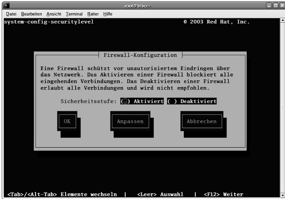
Abbildung 13.1: Das Werkzeug lokkit ist weder schön noch komfortabel. Es ist heute ein textbasiertes Interface des Befehls system-config-securitylevel.
