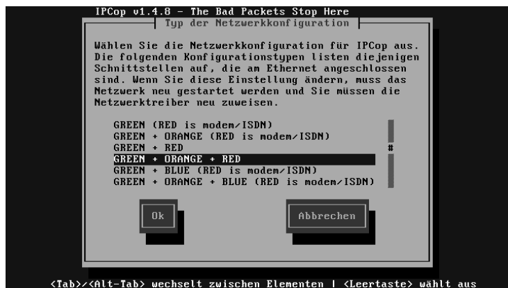
Abbildung 14.3: IPCop weist den Firewall-Zonen Farben zu. Wählen Sie die für Sie richtige Farbkombination aus.
