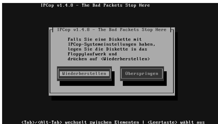
Abbildung 14.1: IPCop unterstützt auch die Wiederherstellung mit einer Backup-Diskette.
