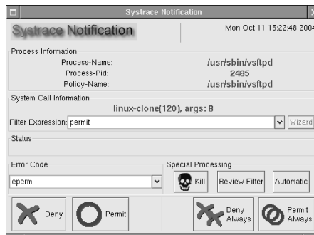
Abbildung 12.2 Systrace fängt den Systemaufruf ab und fragt den Anwender um Erlaubnis.
