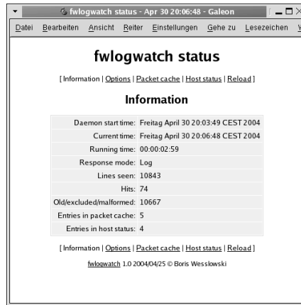
Abbildung 8.2 Im Echtzeit-Modus kann Fwlogwatch seinen Status über ein Webinterface anzeigen.
